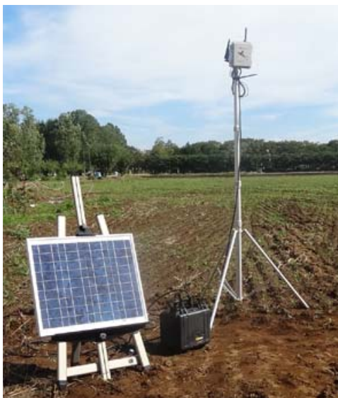
ZIGBEE-FOMA ゲートウェイ (各機器のデータを集めメール送信)
