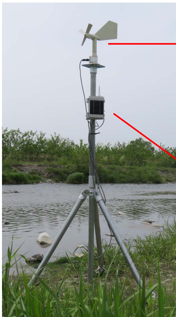
KT-1201 無電源型 風向風速計 光進電気工業製
