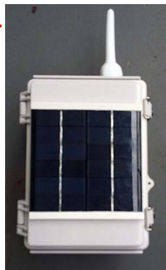
FBS-HORNET-WIND 独立電源 Web 風況観測システム
