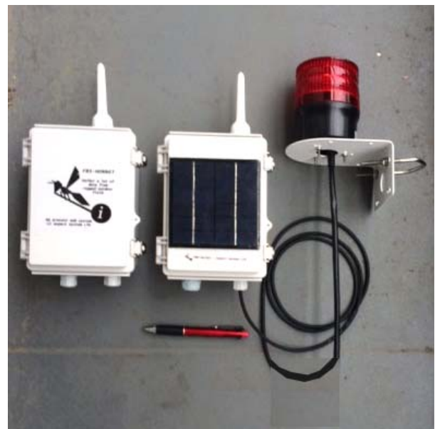
左：乾電池モデル 右：太陽電池モデル + 警報灯(ブザー付き)
