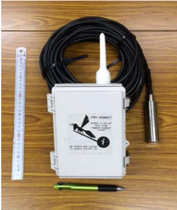
水位観測システム
