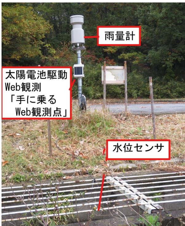
水位と雨量の観測システム
