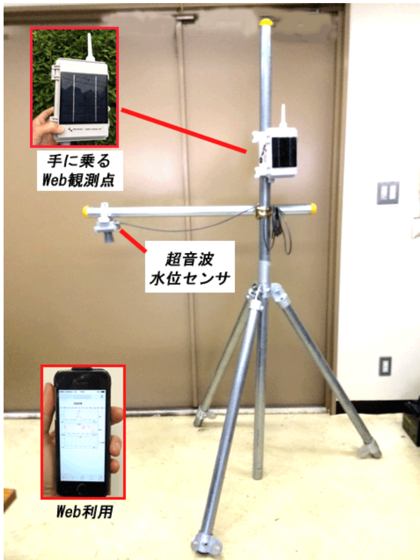
溪流の横に設置する超音波水位 Web 観測システム
