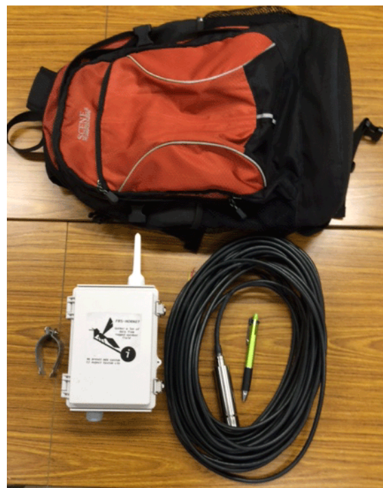
投入式水位センサーと観測システム
