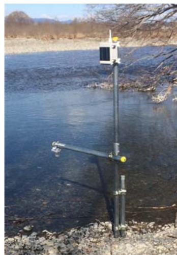
写真3 超音波センサー分離型観測システム
