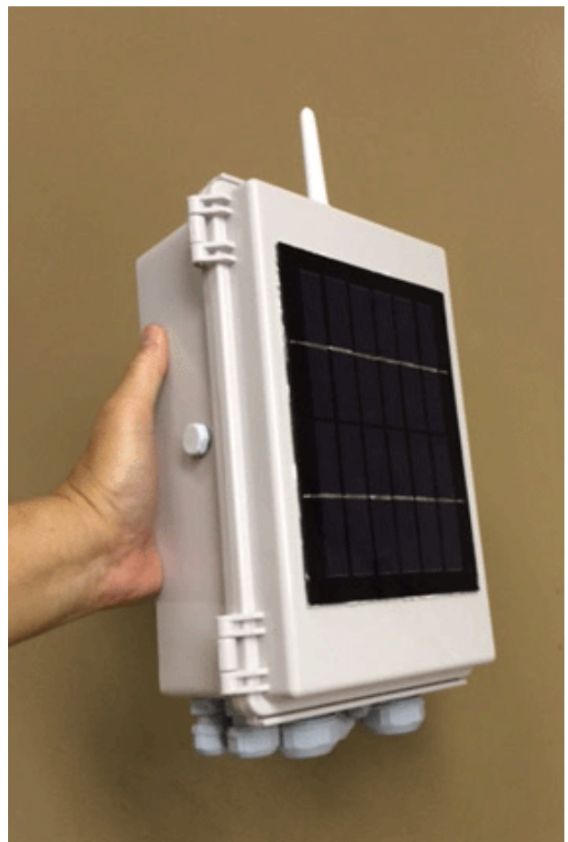
AD 4チャンネル斜面：傾斜+土壌水分 +吸引水頭+雨量の簡易観測
