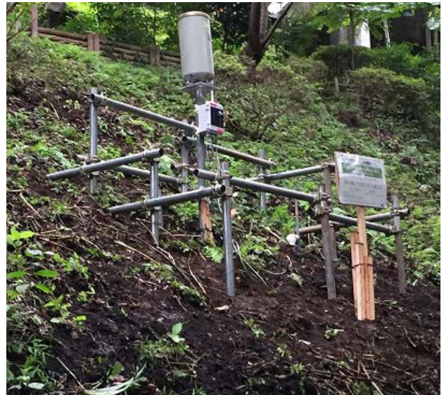
AD 4チャンネル斜面：傾斜+土壌水分 +吸引水頭+雨量の簡易観測
