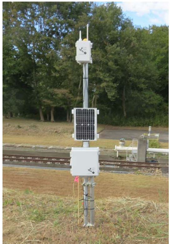
LoRa/3G ゲートウェイ + 地温観測 上から GW、太陽電池、バッテリー
