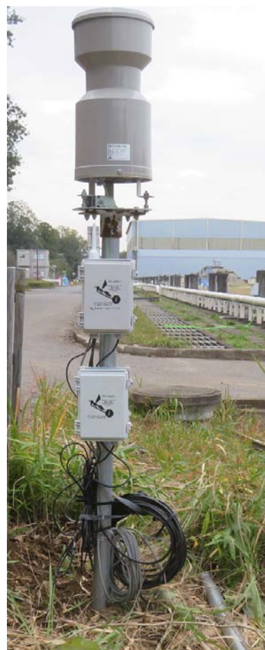
実績:雨量・水位・土壌水分を10分毎観測・1時間毎Web更新で11ヶ月連続で単1×8本と単2×8本使用して実現
