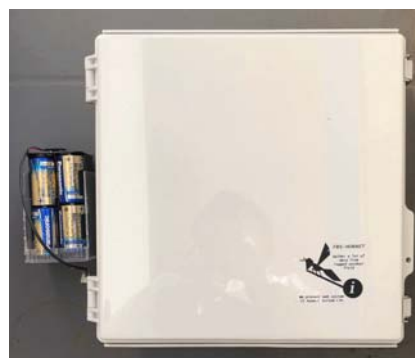
FB-HORNET 観測機器内蔵 2年連続Web観測システム 内蔵:電池駆動観測システム +単1電池×32本 寸法;幅35x高さ35x厚さ18cm 重さ:電池含み8kg 通信;FOMA3G
